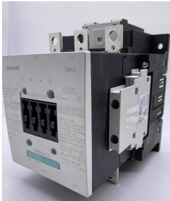
接触器的另一半是活动铁芯，构造和固定铁芯一样，用以带动主接点和辅助接点的闭合断开。20安培以上的接触器加有灭弧罩，利用电路断开时产生的电磁力，快速拉断电弧，保护接点。接触器具可高频率操作，做为电源开启与切断控制时，高操作频率可达每小时1200次。接触器的使用寿命很高，机械寿命通常为数百万次至一千万次，电寿命一般则为数十万次至数百万次。永磁交流接触器是利用磁极的同性相斥、异性相吸的原理，用永磁驱动机构取代传统的电磁铁驱动机构而形成的一种微功耗接触器。国内成熟的产品型号 CJ20 NSFC1 NSFC2 NSFC3 NSFC4 NSFC5 NSFC12 NSFC19 CJ40 NSFMR 绍兴断路器接触器推荐厂家接触器具有可高频率的做电源开启与切断控制，较高操作频率甚至可达每小时1200次也没问题。
