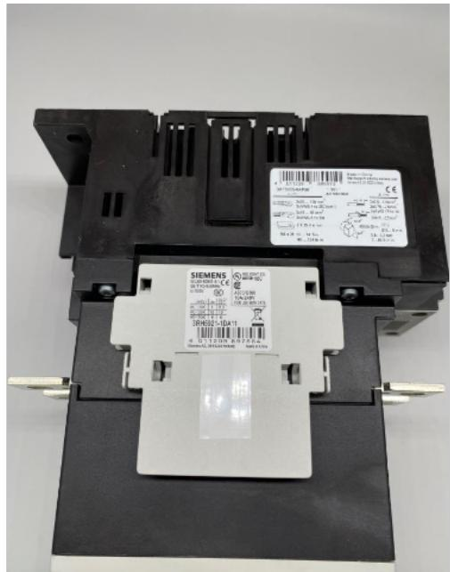
吸力特性与反力特性的合理配合可以提高接触器的寿命。接触器的动作电压为 $85\% \sim 110\% U_n$ 。触头闭合和铁心吸合时使触头产生的一次和二次跳动，可能导致触头熔焊及增大其电侵蚀。为了减小触头跳动时间，应适当减小触头的质量和运动速度，并适当增大触头初接触力。为了减小和防止触头的第二次弹跳（此时因起动电流大，危害性更严重），除借吸力特性与反力特性的良好配合以减小碰撞能量外，还需给电磁系统加装缓冲装置以吸收衔铁等的动能。对于转动式结构，适当地改变衔铁支臂与触头支臂间的杠杆比，可改变触头的接触压力和闭合速度，从而改善触头的弹跳情况。接触器原理与电压继电器相同，只是接触器控制的负载功率较大，故体积也较大。绍兴断路器接触器推荐厂家
